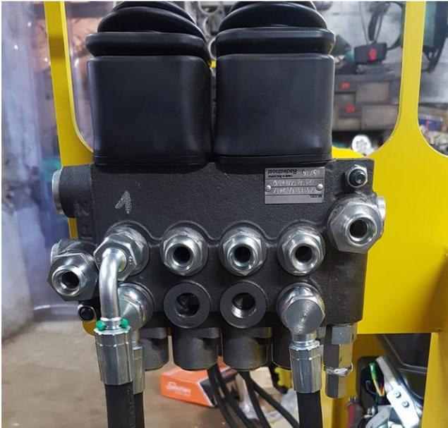
Monter les raccords sur les distributeurs hydraulique
