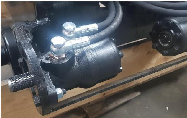
Monter les flexibles des moteurs hydrauliques.
