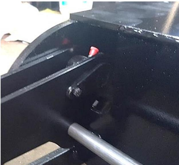
Fixer les têtes de vérins avec 2 axes  $\varnothing 20$  lg 60 avec goutte d'eau.
