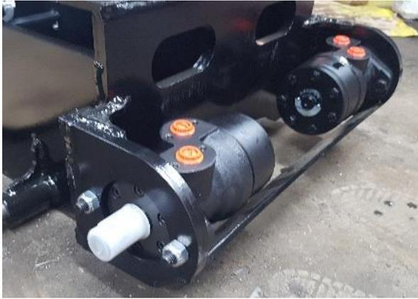
Monter 2 moteurs hydraulique OMR200 sur le châssis avec 2 vis M12x50 et 2 écrous frein par moteur.
