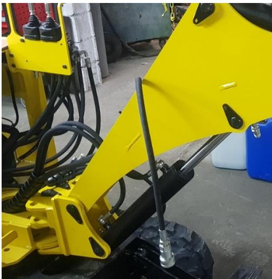
Pour plus de facilité, monter les flexibles en partant du distributeur pour aller au vérin, pour le branchement se référer au schéma p35.
