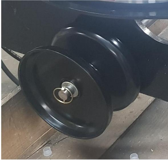
Mettre 1 rondelles  $\varnothing 25$  sur chaque roller avant de placer la goupille.
