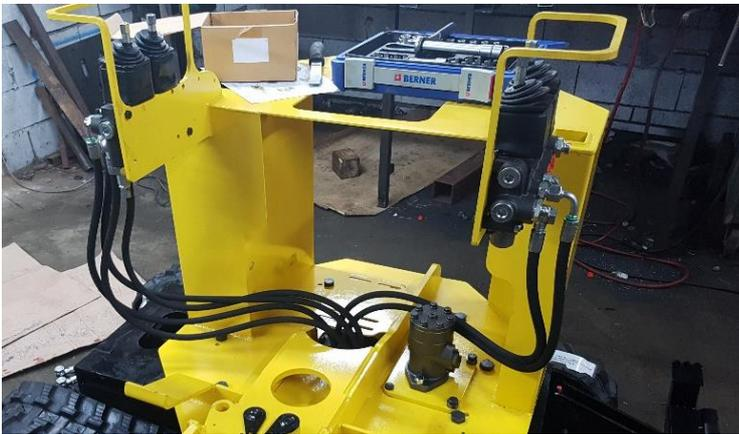
Connecter les flexibles provenant du châssis sur les distributeurs en suivant le schéma de flexible.
