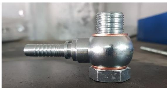
Les vis Banjo se montent avec 2 rondelles cuivre, une au-dessus et une en dessous de la vis.
