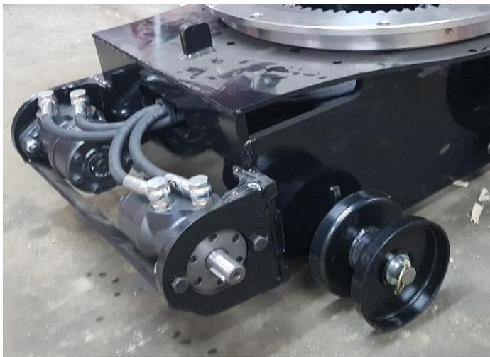
Avant de placer la chenille essayez de monter le barbotin sur les moteurs hydrauliques pour l'ajuster si besoin.
