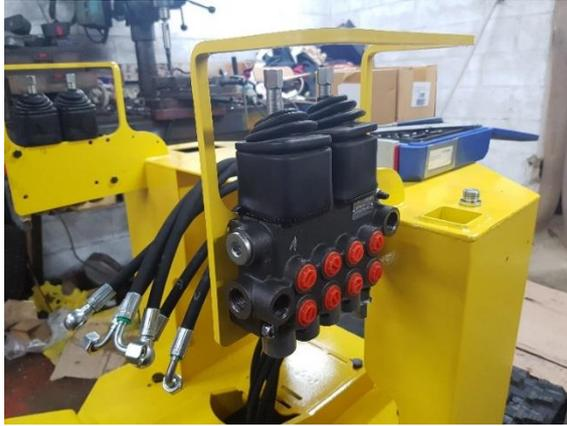
Monter les 2 distributeurs hydraulique.
