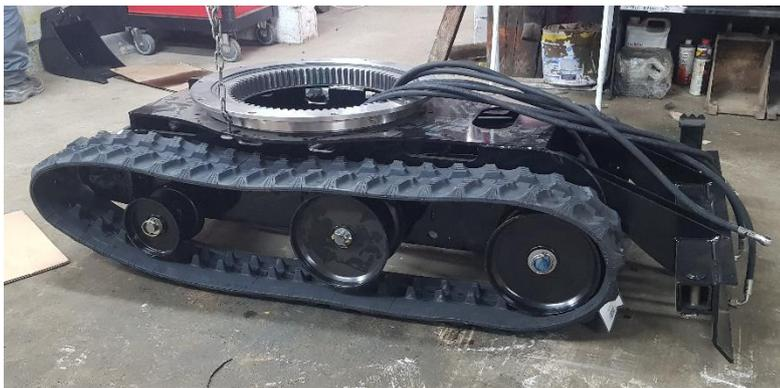
Soulever un coté du châssis ou le châssis complet en fonction des moyens à votre disposition puis positionner les chenilles.
