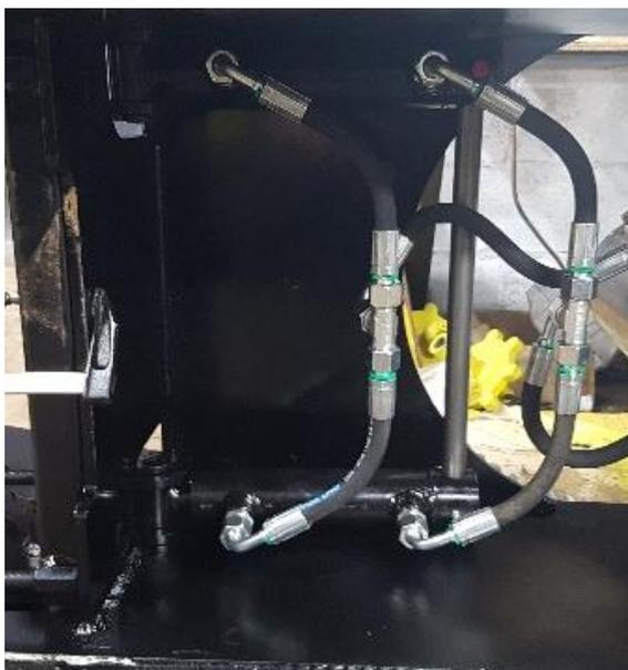
Brancher les flexibles sur les vérins de la lame au T<sub>é</sub> 12L et les flexible du T<sub>é</sub> 12L au distributeur hydraulique.
