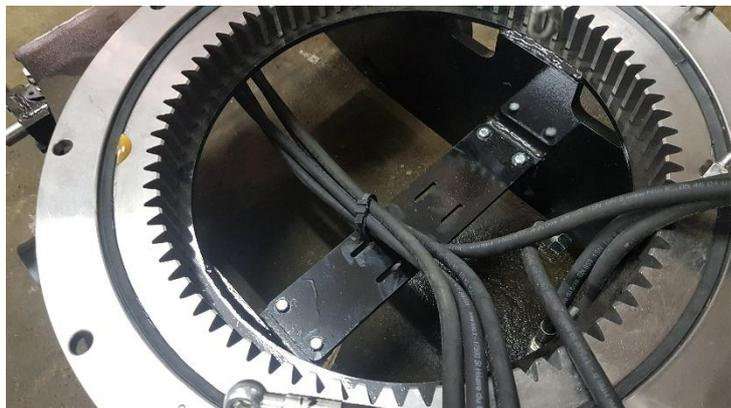
Réaliser un faisceau unique avec les flexibles des moteurs hydrauliques
