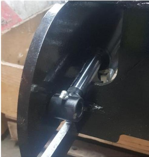
Placer les vérins de 25/40c100 dans le châssis.
