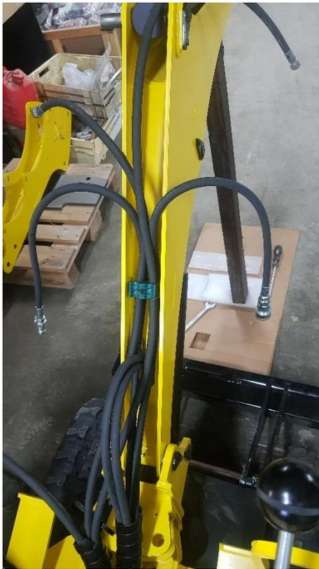
Monter le guide flexible dans le bras pour le maintien des flexibles :
