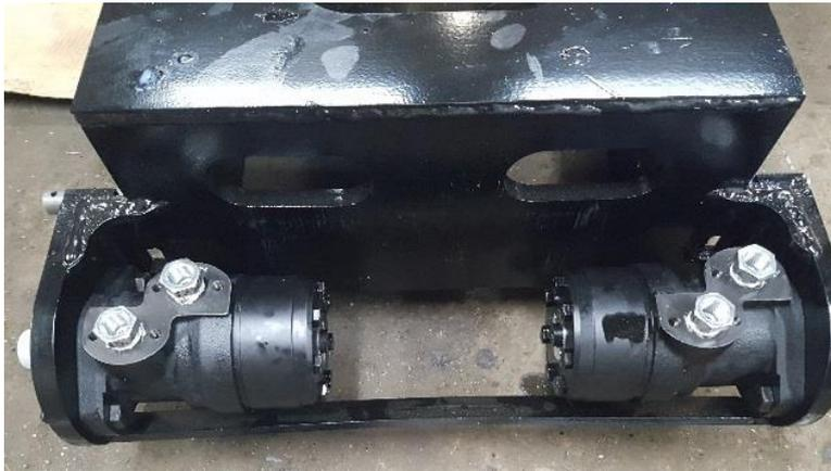
Visser avec du ruban téflon 2 réduction MC1/2-F3/8 par moteur.
