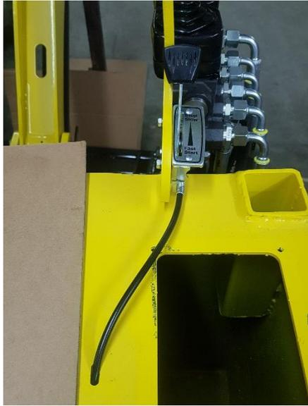
Monter l'accélérateur sur le support distributeur droit et faire passer la gaine dans le trou oblong à côté du réservoir.
