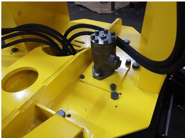
Positionner le moteur hydraulique, attention celui-ci a 2 positions possible en fonction des couronnes, pro ou standard.
