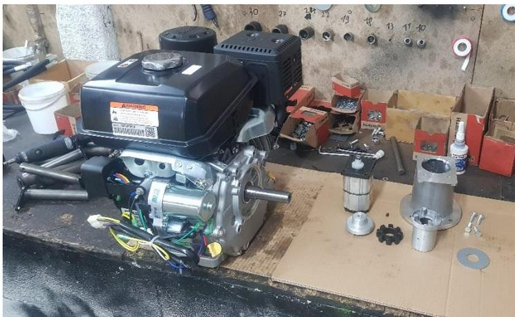
Faire le niveau d'huile dans le moteur thermique par un des 2 bouchons présent sur chaque côté du moteur. L'un de ces bouchons possède une jauge pour le niveau d'huile. Retirer la clavette puis démarrer le moteur pour vérifier qu'il n'y ait pas de problèmes.
