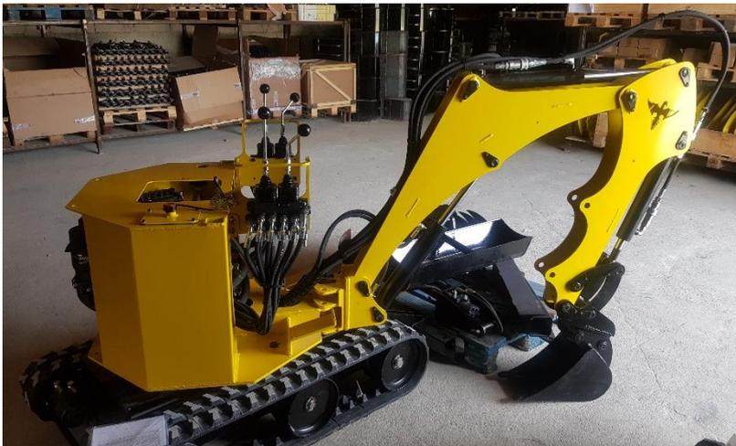
Vérifier au niveau des articulation de chaque bras que les flexibles aient assez de jeu pour ne pas être endommagé lors de l'usage de la machine.
