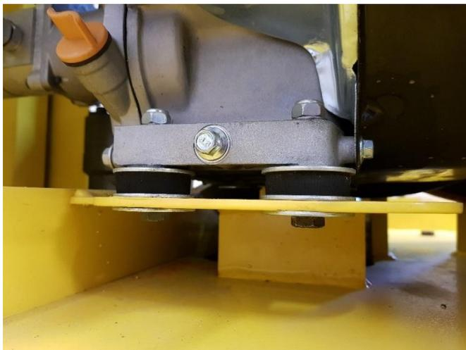
Fixer le moteur sur le châssis avec 4
