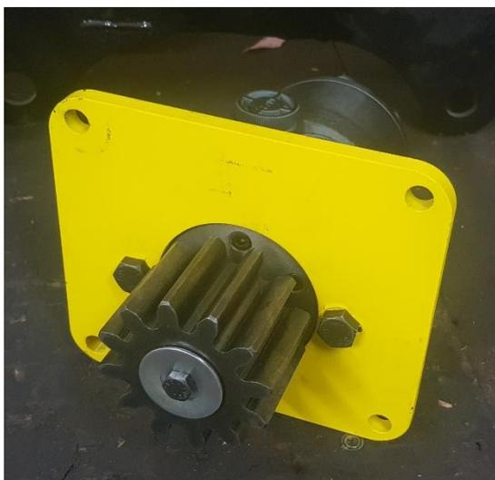
Monter le pignon sur le moteur hydraulique puis le verrouiller avec une vis de 8x40 + rondelle large.
