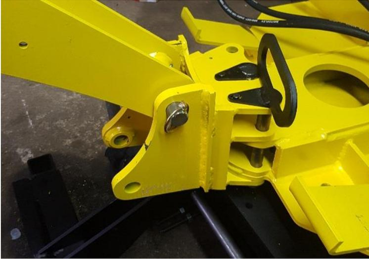
Monter la noix avec un axe  $\varnothing 25$  lg 210 au centre et d'un côté un axe  $\varnothing 25$  lg 210 avec poignée.
