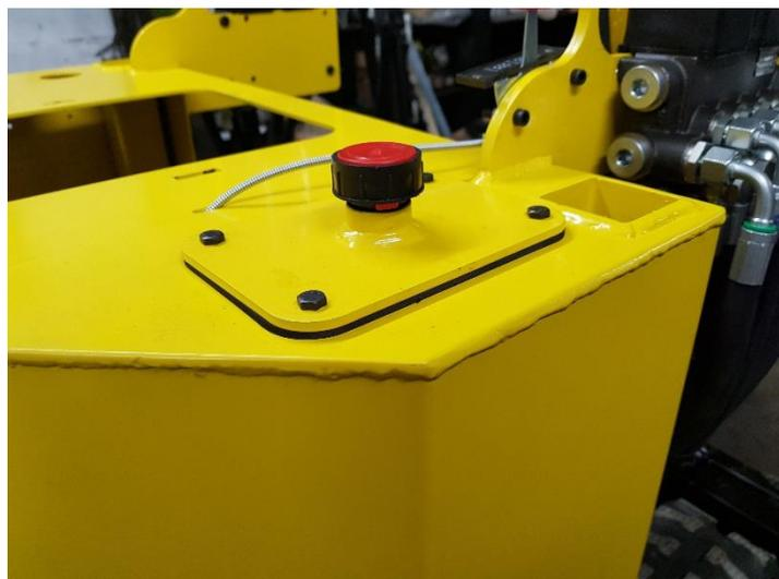
Remplir le réservoir d'huile hydraulique et monter la plaque réservoir avec au moins 2 vis pour la tenir en place (celle-ci devra être retirée pour refaire le niveau après le premier démarrage).
