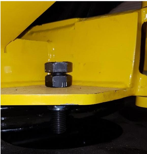
Placer la vis M20 x 80 avec écrou et contre écrou pour régler la hauteur.
