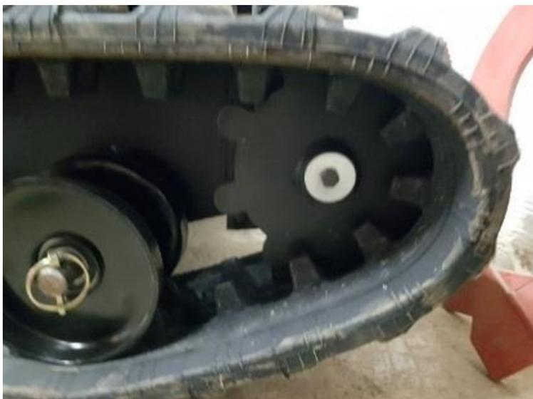
Placer la chenille sur les rollers puis positionner l'engrenage dans la chenille et tirer sur la chenille pour emboîter l'engrenage sur l'arbre du moteur hydraulique.
