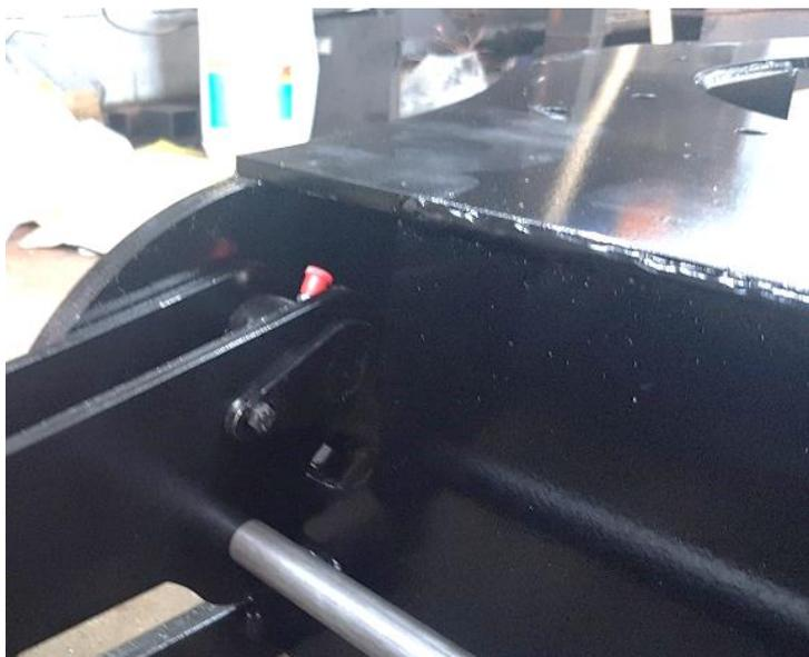
Fixer les têtes de vérins avec 2 axes goutte d'eau Ø 20 lg 60.
