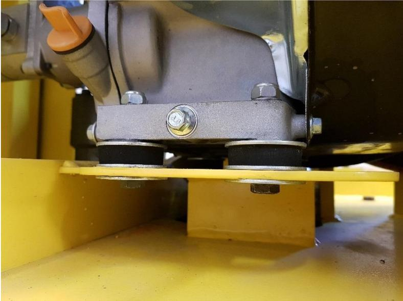
Fixer le moteur sur le châssis avec 4 boulons M8x60, 12 rondelles larges, 4 rondelles caoutchouc et 4 écrous M8 Frein.
