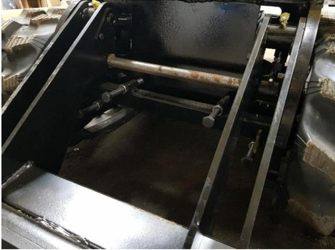
Tendre légèrement les chenilles grâce aux 4 vis tendeur, attendre la fin du montage pour réaliser la tensions finale une fois les moteurs hydrauliques en huile.
