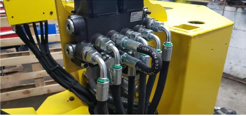
Dans la couronne de flexible, vous trouvez un petit flexible, celui-ci permet de relier les orifices de la ligne auxiliaire si vous n'avez pas commandé l'option.
