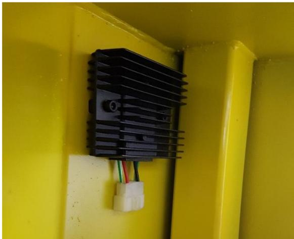
Le moteur Kohler 9.5 cv dispose d'un régulateur de charge, ne pas oublier de connecter celui-ci une fois la batterie branchée.
