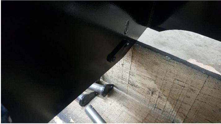
Verrouiller les axes arrière par l'intérieur avec une vis 6x12 collé
