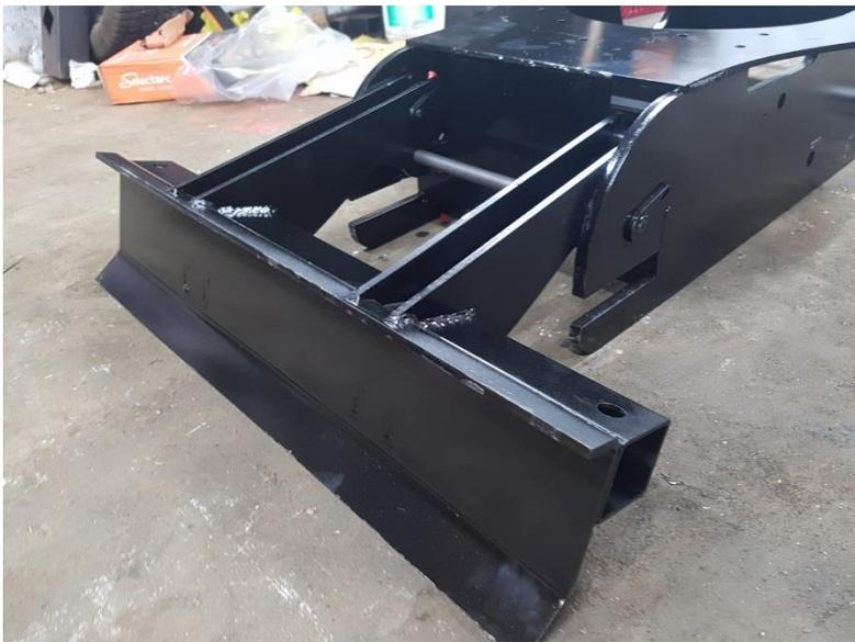
Monter la lame stabilisatrice avec un axe Ø25 lg 450.
