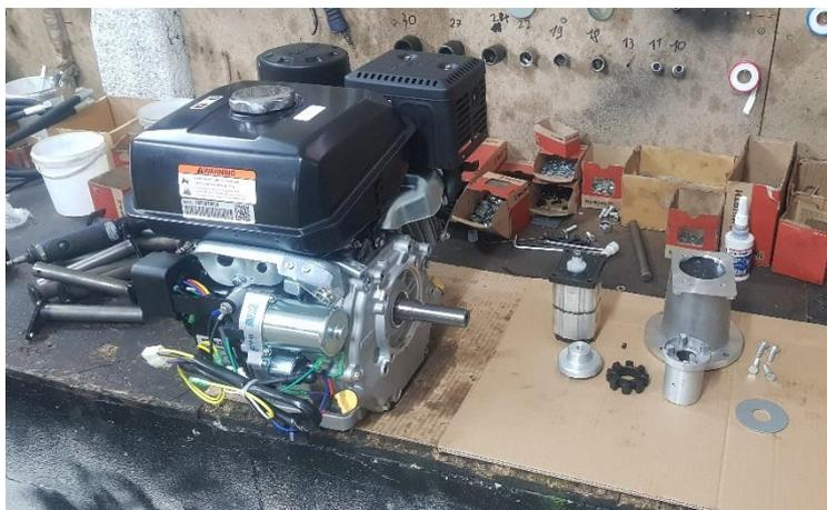
Pour commencer, faire le niveau d'huile dans le moteur thermique, remplir par un des 2 bouchons sur chaque côté du moteur.
