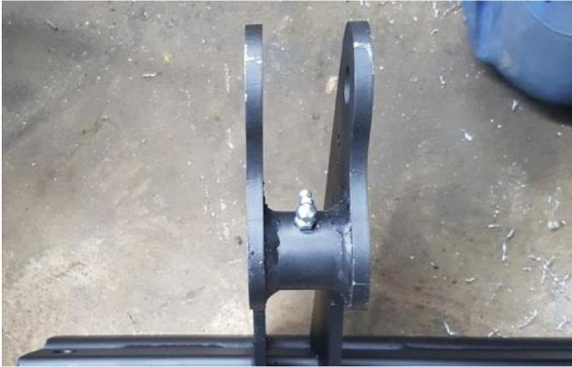
Commencer par monter les graisseur M6 à 90° sur de chaque côté de la lame et sur les 2 triangles rollers
