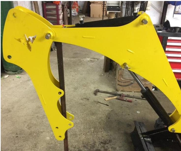
Monter les bras sur la machine puis monter les vérins.
