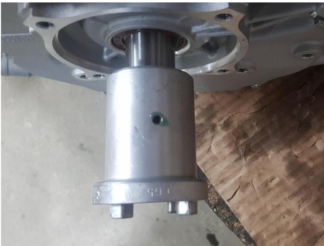
Monter la vis de blocage sans tête en collant la vis pour ne pas qu'elle se défasse a l'usage.
