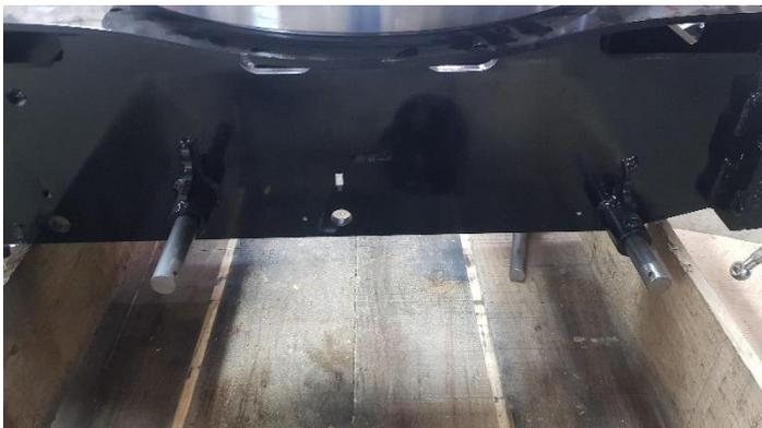
Mettre en place les axes des rollers :
