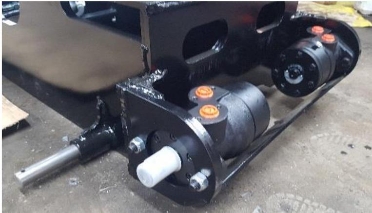
Monter les 2 moteurs hydraulique OMR200 sur le châssis avec 2 vis M12x50 et 2 écrous frein par moteur.
