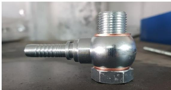
Les vis Bandjo se montent avec 2 rondelles cuivre, une au-dessus et une en dessous de la vis.
