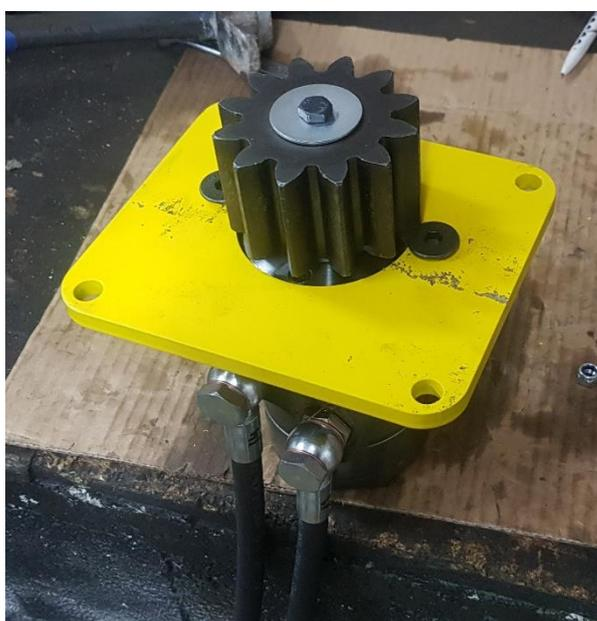
Monter l'engrenage sur un moteur hydraulique :
