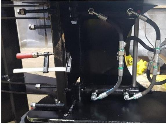
Fixer l'arrière des vérins avec un axe  $\varnothing 20$  lg 450 verrouiller par une goutte d'eau sur le flanc (coller la vis M6x16).
