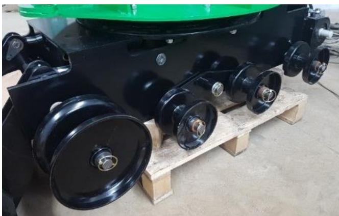
Monter les roller  $\varnothing 160$  sur les triangles avant de les monter sur le châssis puis le roller  $\varnothing 240$  sur l'arbre tendeur.
