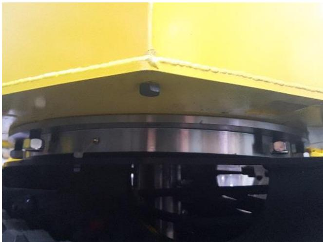
Visser avec du ruban téflon une vis de M12 x 20 sous le réservoir (vis de vidange) et bien serré celle-ci pour ne pas perdre d'huile.
