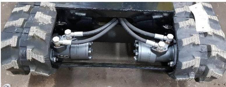
Brancher les flexibles des moteurs hydrauliques en suivant le schéma hydraulique en début de notice.
