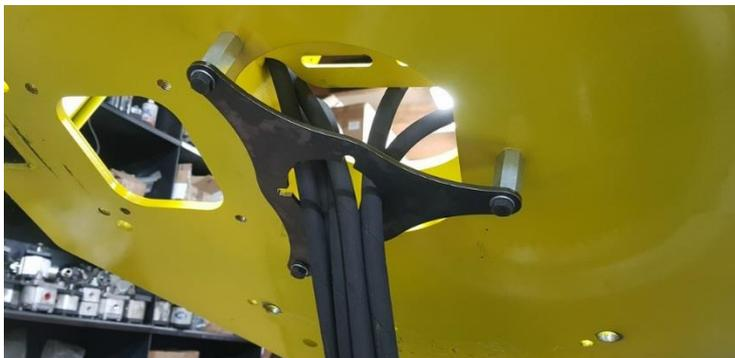
Placer la fixation du joint tournant sur le bas de la plateforme supérieure.
