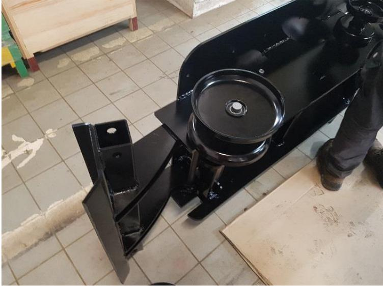
Basculer le châssis sur le côté, cela est plus simple pour monter les rollers et les chenilles.
