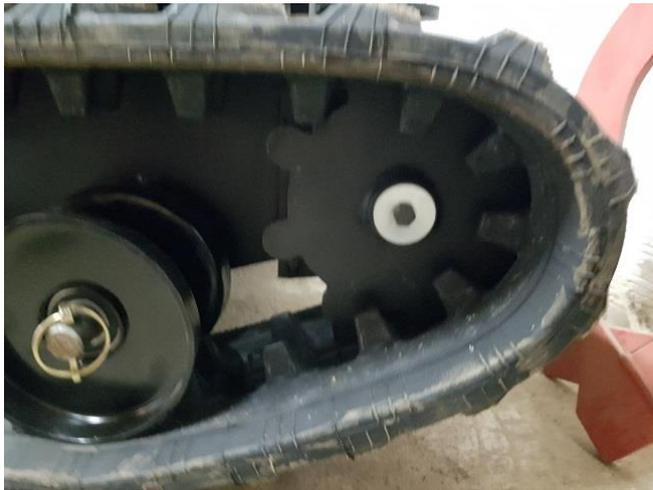
Verrouiller les engrenages de chenilles avec 1 vis 8x50 et 1 rondelle Ø8 large. Coller la vis de 8x50 pour que celle-ci ne se devise pas lors de l'utilisation
