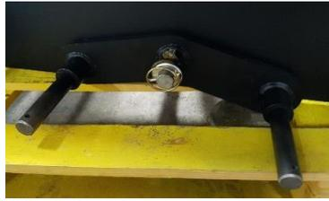
Commencer par monter les graisseur M6 à 90° sur de chaque côté de la lame et sur les 2 triangles
