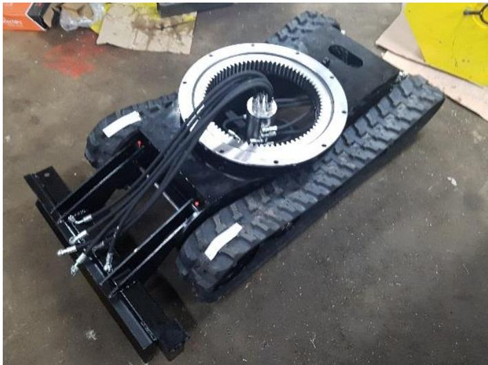
Monter tous les flexibles sur la partie supérieure du joint tournant. Repérez les flexibles avec les chiffre et les lettres sur les bouts libre.
