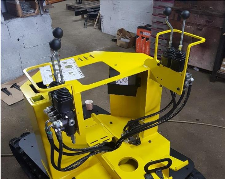
Monter les 2 distributeurs ensuite sur le châssis puis brancher les flexibles du châssis bas à leur emplacement final sur les distributeurs.
