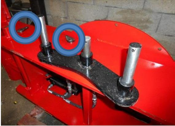
Verrouiller les axes de lame et des vérins avec les gouttes d'eau (en bleu).
