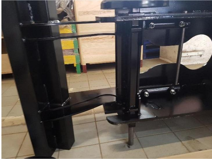
Monter la lame stabilisatrice avec un axe  $\varnothing 25$  lg 455 puis les 2 vérins de lame avec un axe  $\varnothing 20$  lg 455 dans le châssis.
