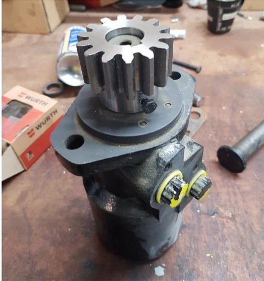
Monter l'engrenage sur un moteur hydraulique :
