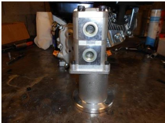
Placer la pompe sur la lanterne avec les 4 vis BTR de 6x25 (coller une des vis afin que l'ensemble ne se desserre pas avec les vibrations).
