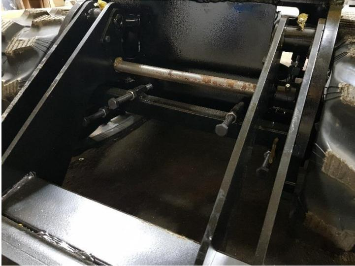
Tendre légèrement les chenilles grâce aux 4 vis tendeur, attendre la fin du montage pour réaliser la tension finale une fois le moteur hydraulique en huile.
