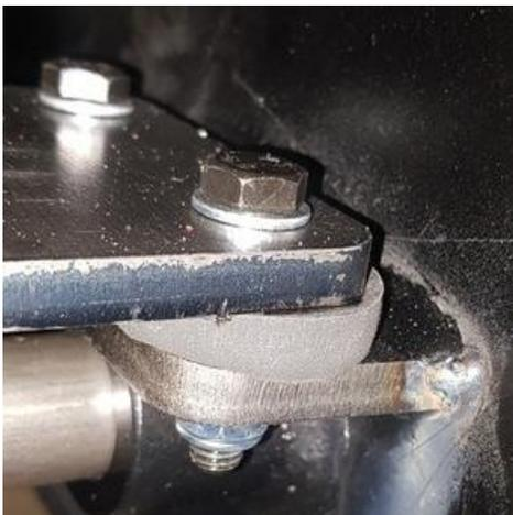
Monter la plaque support joint avec 4 rondelles caoutchouc et les vis de 8x50 TH
