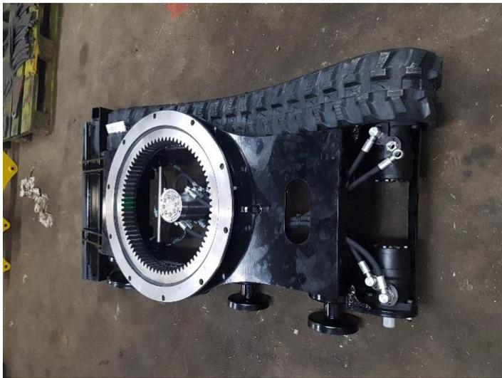
Positionner la couronne d'orientation sur le châssis, attention à ce que la partie dentée soit fixée au châssis du bas.
