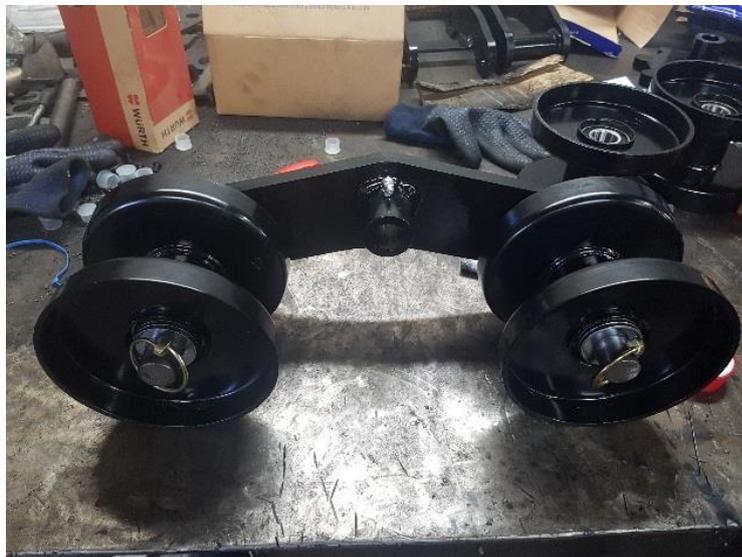
Monter un graisseur à 90° sur la bague du centre puis monter les 2 rollers  $\varnothing 160$  sur les axes directement sur les bagues et avec 2 rondelles avant la goupille.
