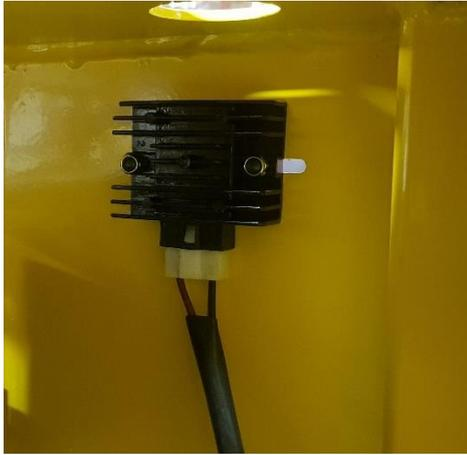
Monter le régulateur de charge sur le châssis, gratter la peinture pour que celui-ci soit correctement connecté à la masse sur le châssis.
