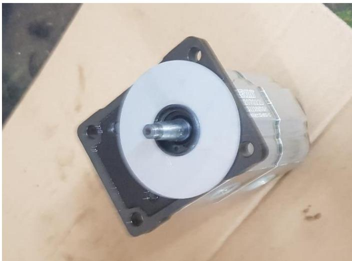
Retirer la protection en plastique et monter la rondelle de centrage sur la pompe.
