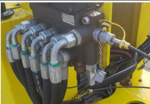
Visser le flexible sur le raccord monté sur le distributeur.
