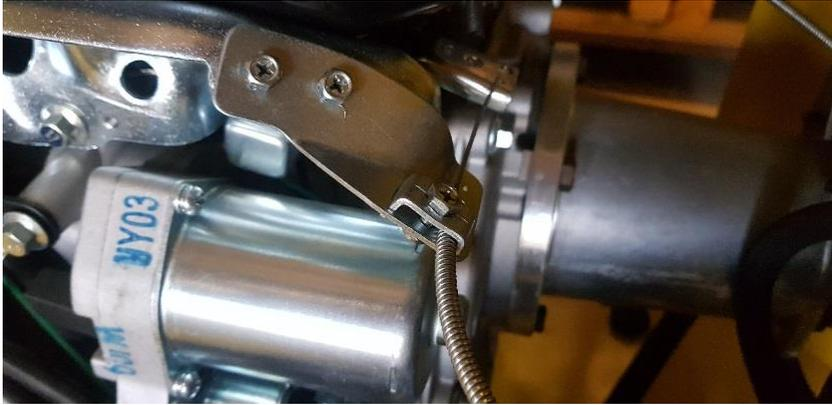
Le maintenir en place en serrant la vis du guide puis bouger la manette d'accélérateur du haut en le tirant et poussant plusieurs fois pour s'assurer qu'il n'y a pas de gêne à son utilisation puis vérifier le bout câble pour être sûr qu'il ne bouge pas. Si il y a de la friction, ajouter du lubrifiant de chaque côté de la gaine d'accélérateur.
