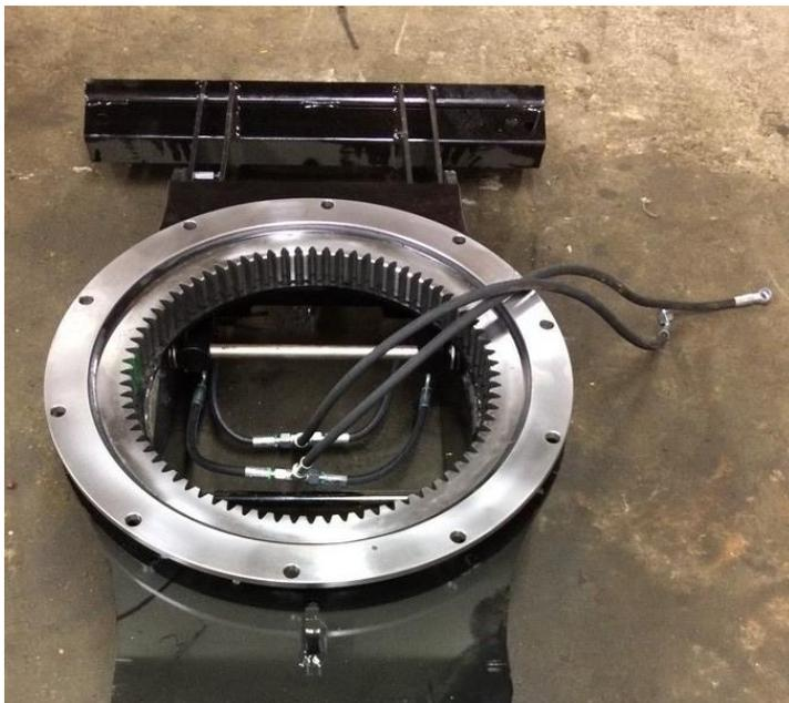
Monter la couronne d'orientation sur le châssis.
