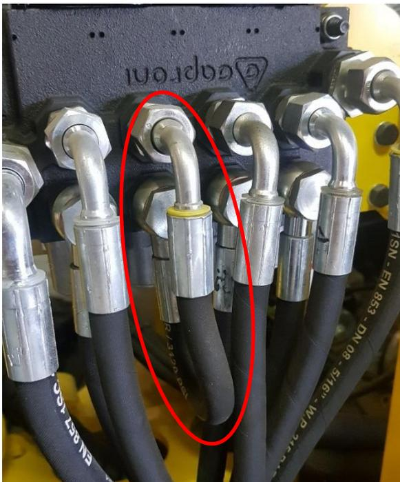
La ligne 15-16 n'est pas utilisée de série, celle-ci est obstruée avec un flexible en bypass.
