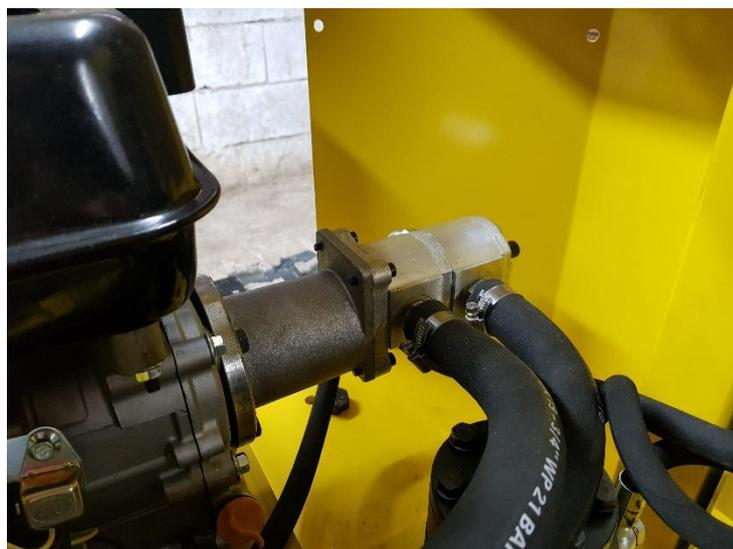
Connecter les flexibles d'alimentation du réservoir aux pompes et les flexibles d'alimentation et retour des distributeur.
