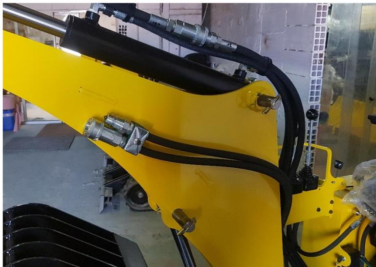
Ligne hydraulique pour bras télescopique, ce sont 2 flexibles tiré depuis un des distributeurs jusqu'au bras de levée pour y raccorder le bras télescopique.
