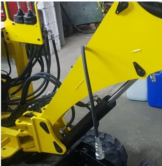
Pour plus de facilité, monter les flexibles en partant du distributeur pour aller au vérin, pour le branchement se référer au schéma p36.
