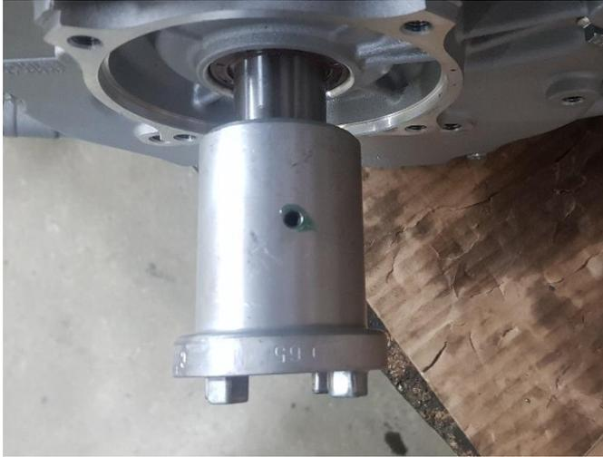
Monter la vis de blocage sans tête en la collant avec du frein filet.
