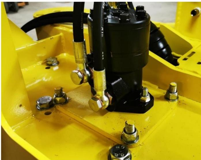
Positionner le moteur hydraulique, faites attention à ce que la dentelure soit bien enclenchée.
