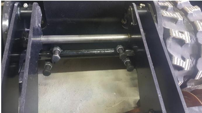
Tendre légèrement les chenilles puis attendre la fin du montage pour réaliser la tension finale une fois les moteurs hydrauliques en pression.
