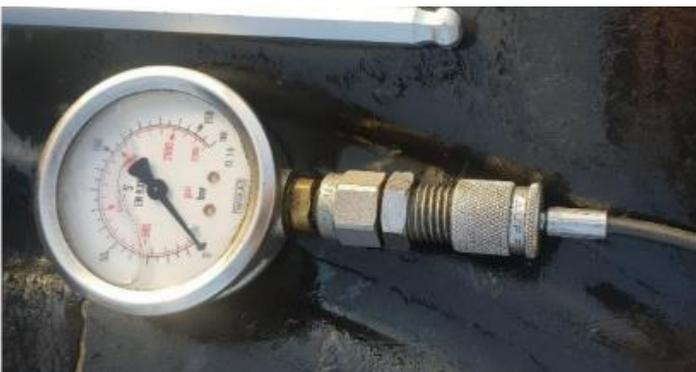
Monter le raccord 1/4 femelle sur le manomètre et visser le flexible dessus.
