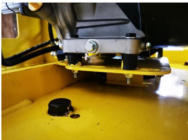
Positionner le moteur thermique sur les silentblocs puis visser le avec des vis de 8x35 + rondelle 8x30 coté trou oblong et M8 sur les perçages classiques. Une fois les 4 vis positionner, vous pouvez verrouiller l'ensemble.
