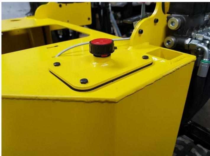
Remplir le réservoir d'huile hydraulique et monter la plaque réservoir avec au moins 2 vis pour la tenir en place (celle-ci devra être retirée pour refaire le niveau après le premier démarrage). Laisser au moins 5 cm sous les retours pour que l'huile puisse s'expandre sans déborder
