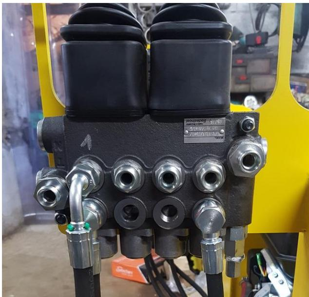
Monter les raccords sur les distributeurs hydraulique
