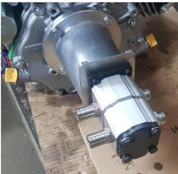
Monter les raccords sur la pompe, 2 raccords UM12L-12x17 coté pression 2 raccords cannelé EC19MC3/8 coté aspiration avec 2 rondelles cuivre Ø17 pour l'étanchéité.
