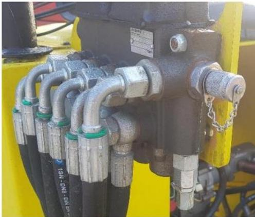
Monter le raccord male 1/2 sur le distributeur.
