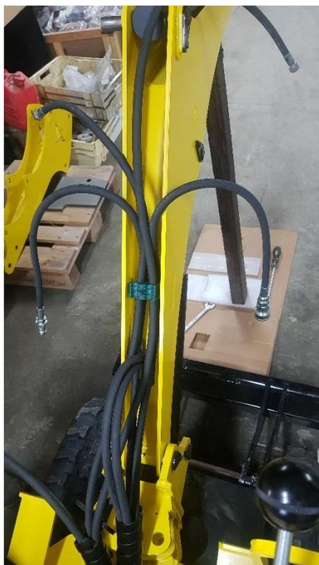
Monter le guide flexible dans le bras pour le maintien des flexibles :
