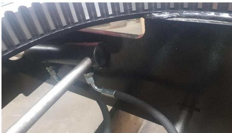
Placer les vérins de 25/40c100 dans le châssis.
