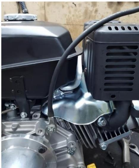
Brancher le fil de masse sur une des vis du carter du moteur et au - de la batterie.
