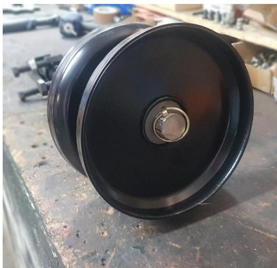
Mettre 1 rondelle Ø35 sur le tendeur avant de placer la goupille de chaque côté.
