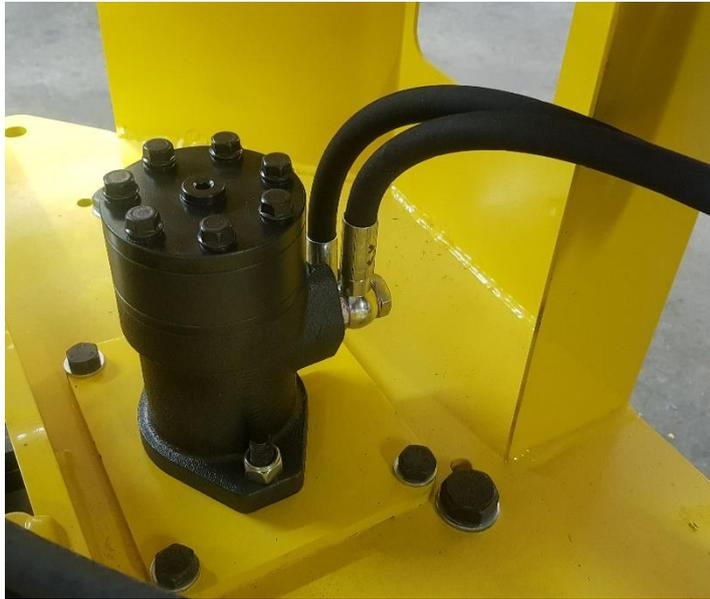
Monter les flexibles sur le moteur hydraulique jusqu'au distributeur.
