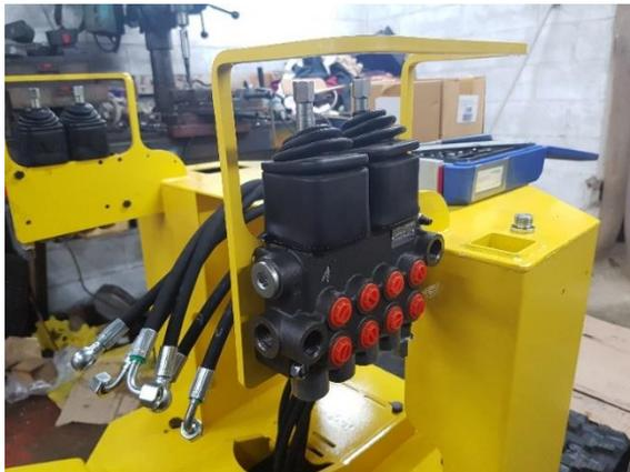
Monter les 2 distributeurs hydraulique.
