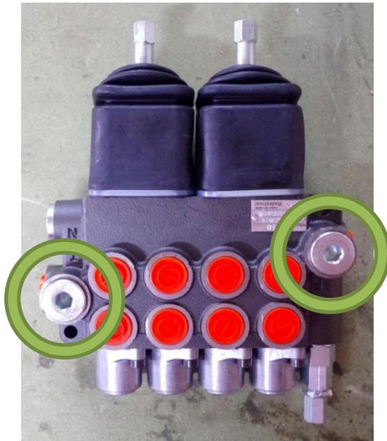
Sur la face avant des distributeurs, démonter les bouchons en acier qui sont en façade puis les remonter sur les côtés du distributeur à la place des bouchons plastique rouge.
