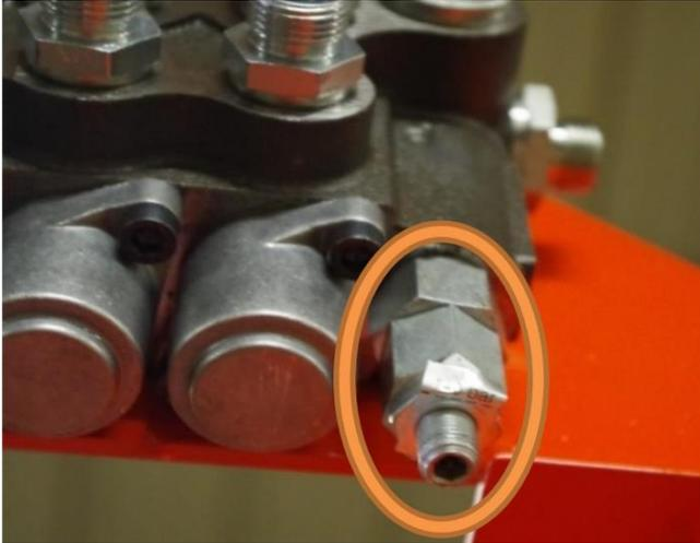
Si votre machine n'a pas de puissance faites  $\frac{1}{4}$  de tour par  $\frac{1}{4}$  de tour en serrant la vis jusqu'à avoir assez de puissance pour que les moteurs d'avancement fonctionnent normalement. Ne pas serrer plus que nécessaire pour ne pas endommager la pompe.
