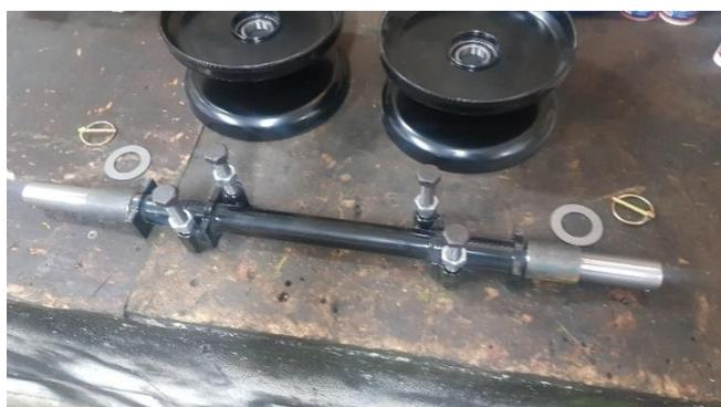
Mettre un tube Ø42 lg 55 de chaque côté pour déporter le roller.
