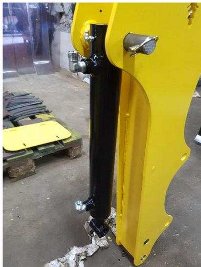
Monter le bras de balancier et un vérin de 30/50 c 300 au bout du bras.
