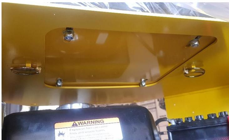
Monter le siège à travers les mortaises présente sur la tourelle et mettre 2 goupilles pour maintenir celui-ci en place.
