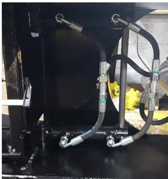
Brancher les flexibles sur les vérins de la lame au T<sub>12</sub>L et les flexible du T<sub>12</sub>L au distributeur hydraulique.
