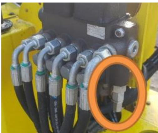
Commencer par repérer la soupape de sécurité, celle-ci indique le point d'entrée de l'huile hydraulique et permet le réglage de la pression de service.
