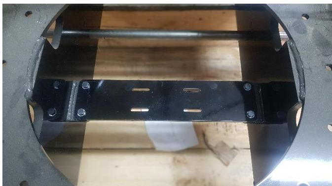
Monter la plaque support Joint Tournant au centre du châssis, si applicable.
