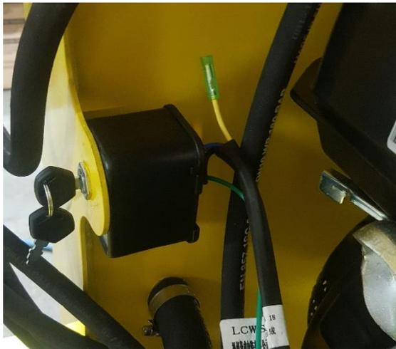
Démonter le contacteur a clé du moteur, couper les 2 pates de fixation et le visser en passe cloison sur le trou en façade du carter.
