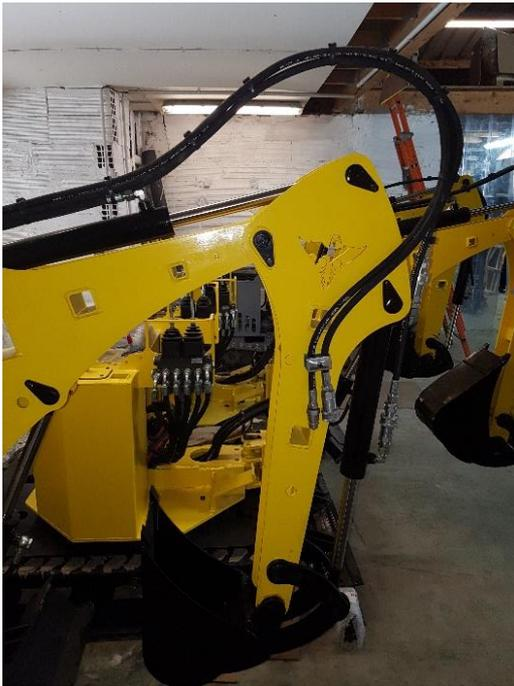
Ligne hydraulique supplémentaire en bout de flèche sont 2 flexibles tirés depuis les distributeurs jusqu'au bras de balancier.
